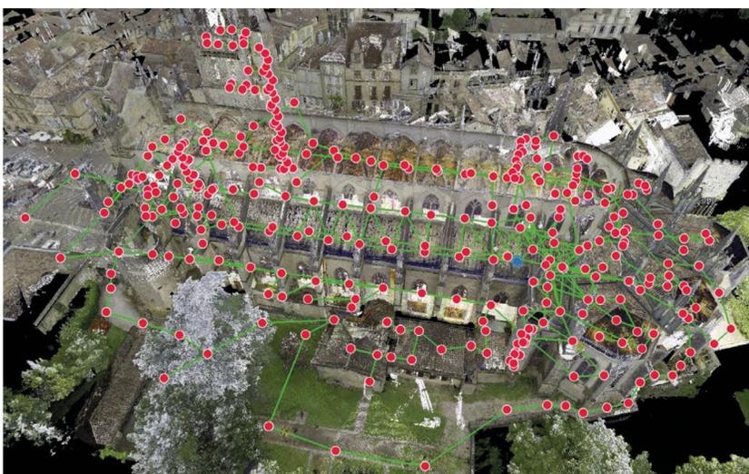
Le programme de numérisation de l'édifice se déroule sur deux ans. Il permet de révéler la structure et conserver la mémoire de sa construction. Cette numérisation, d'une précision millimétrique, permet d'acquérir les volumes généraux du bâtiment. Le recours à la technique du scan 3D consiste à balayer chaque cm<sup>2</sup> du bâtiment avec un
